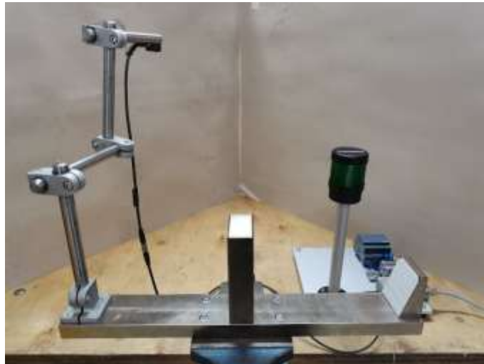
Ausgangsstellung, alle Verstellschrauben angezogen mit 12 Nm
